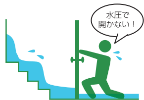
豪雨時の地下室利用は危険です！
