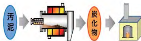
汚泥炭化施設
