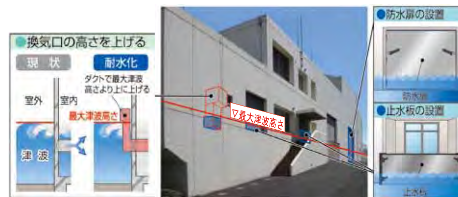
ポンプ所などの耐水対策
