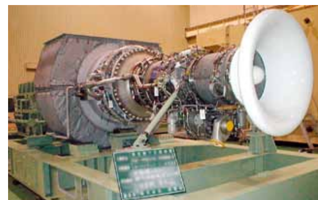
ガスタービン発電機(13,000kVA)
