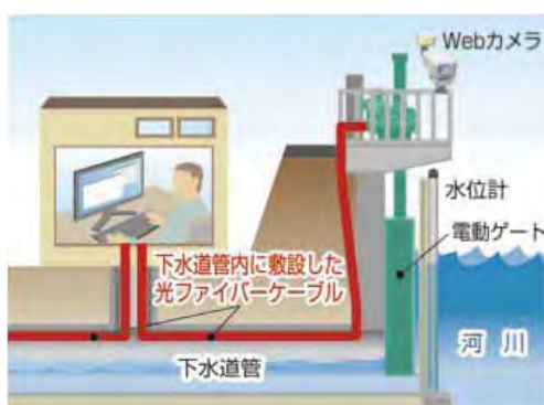
高潮防潮扉の遠方制御による自動化のイメージ
