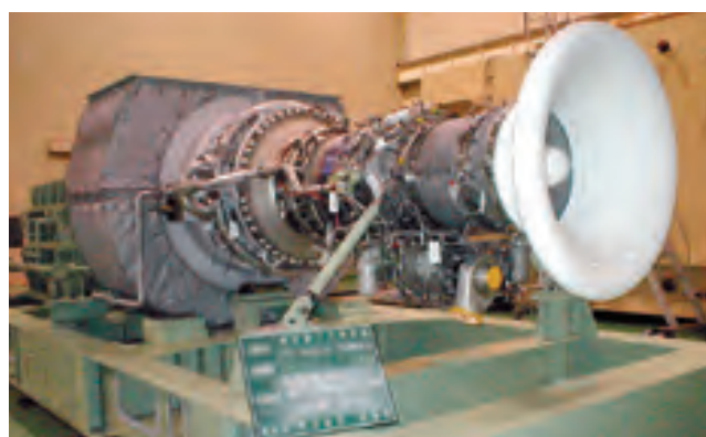
ガスタービン発電機(13,000kVA)
