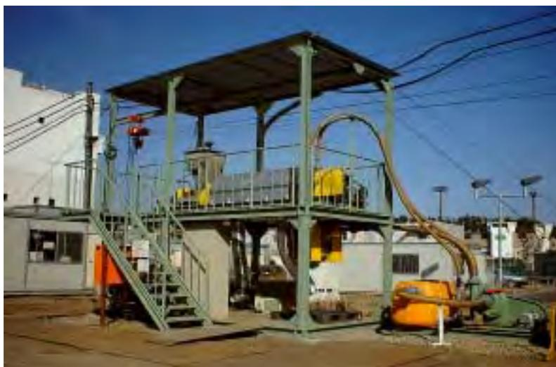
焼却灰に含まれる重金属類の不溶化技術の実験設備
