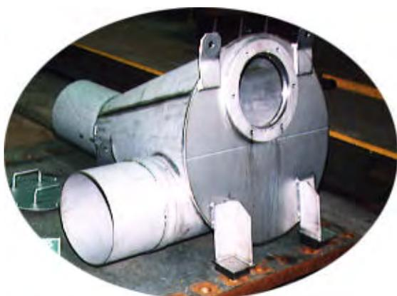
写真 - 4.1 Vortex Valve (実物)
