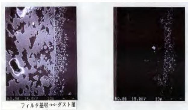
写真 - 1 6mmピッチフィルタ断面の電子顕微鏡写真(2枚横並び)
