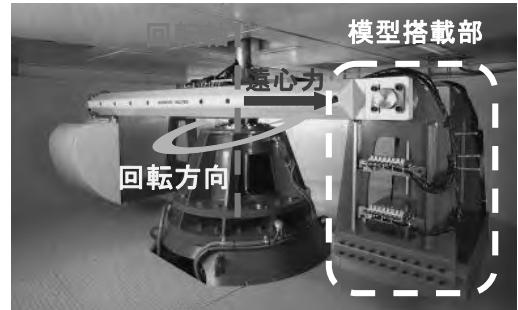
図7 遠心載荷模型実験装置
