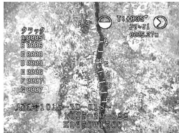
図 19 管内調査画像及び計測画像
