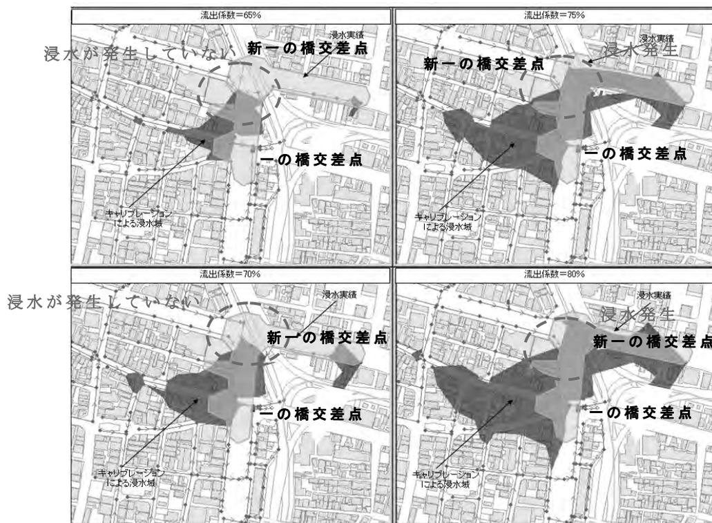
図6 平成16年10月9日(台風22号)におけるキャリブレーション結果(一の橋交差点付近)
