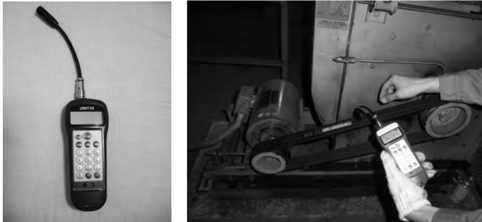
図-4 音波式ベルト張力計（左）新手法による張力管理状況（右）
