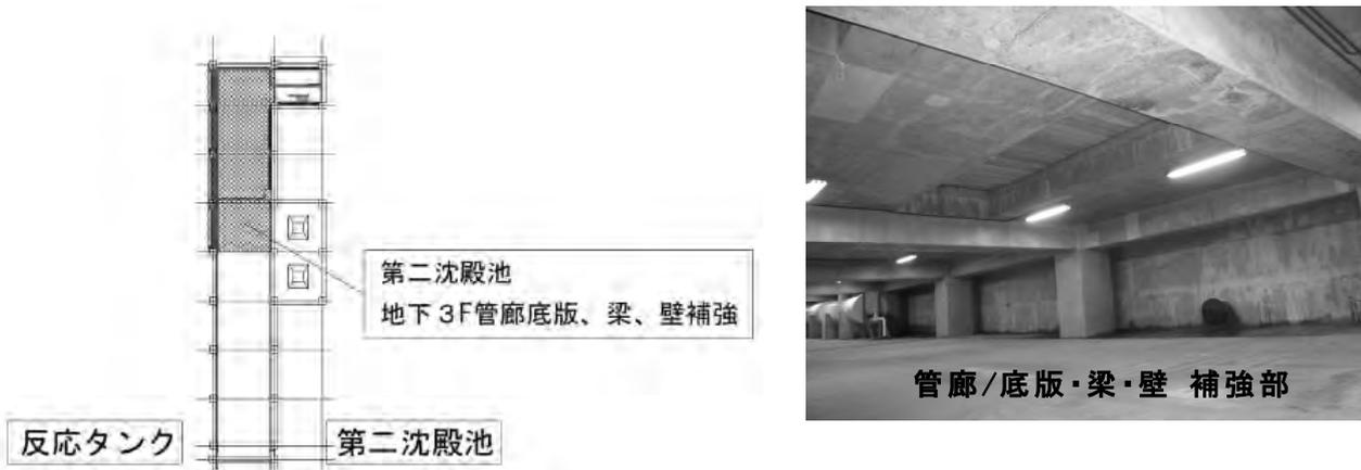
図-9 耐震補強箇所 (B3F)
