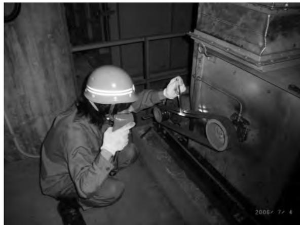
図-2 バネ式たわみ張力計（左）従来方式による張力管理状況（右）
