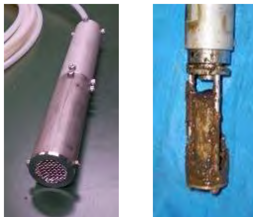
図 10 開発当初の簡易型水位検出器の外観及びフロートとフロートガイド間の詰まり
