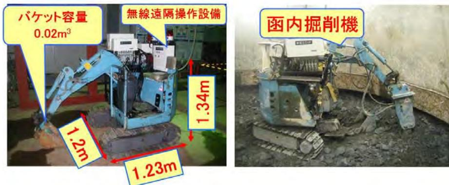
詰込用(バケット装着)      破碎用(ブレーカー装着)
