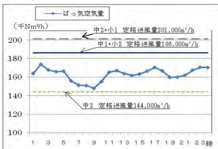
図-4 本系+西系ばっ気空気量と送風機定格送風量
