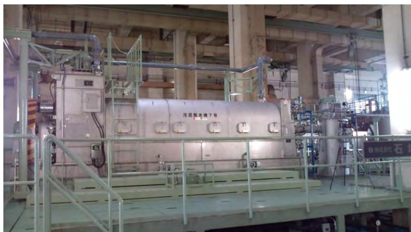
図-2 高効率型圧入式スクリュープレス脱水機
