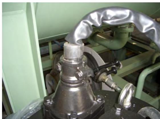
図5 熱収縮チューブによる保護
