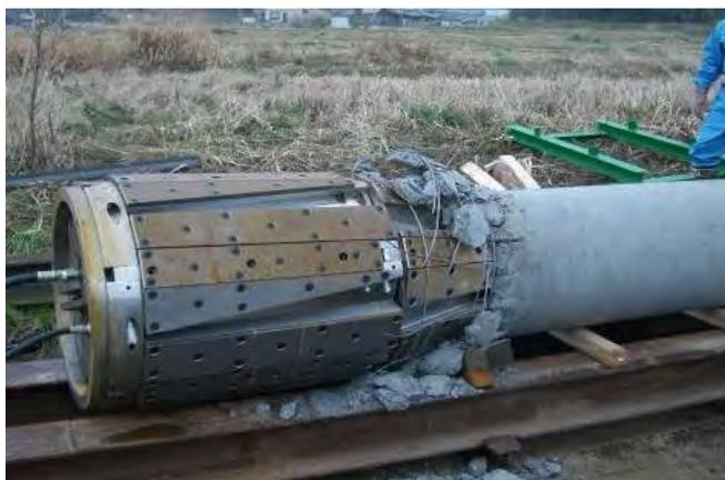
図 11 ヒューム管破碎状況（試験時）
