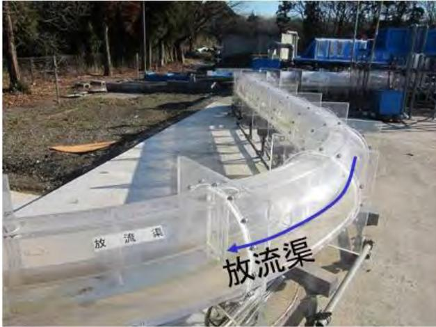
図 7 連絡管模型写真
