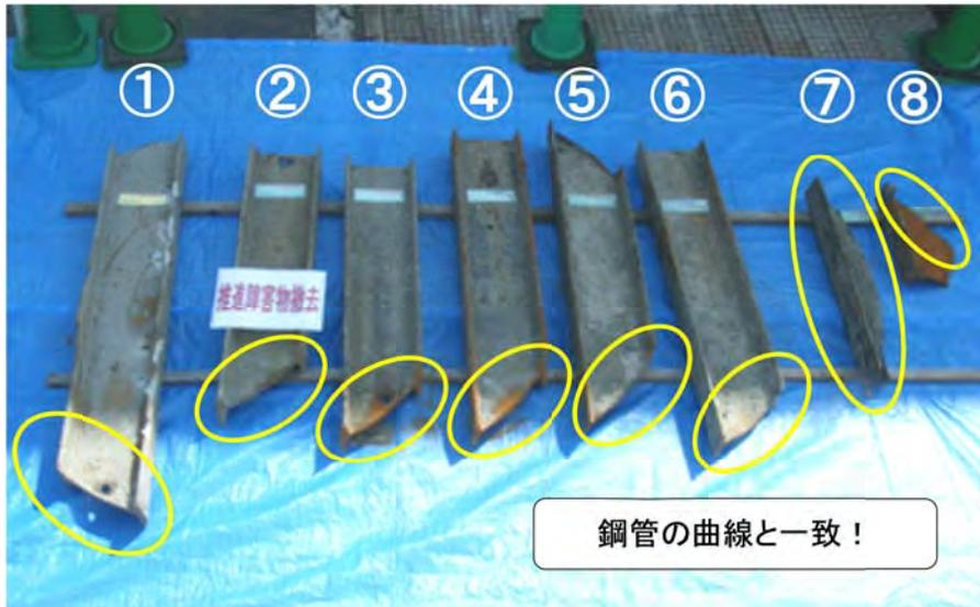
図13 地中障害物撤去片
