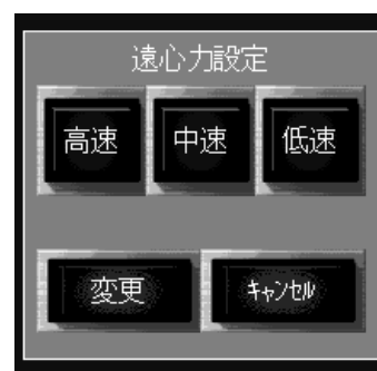
図－8 遠心力選択システム
