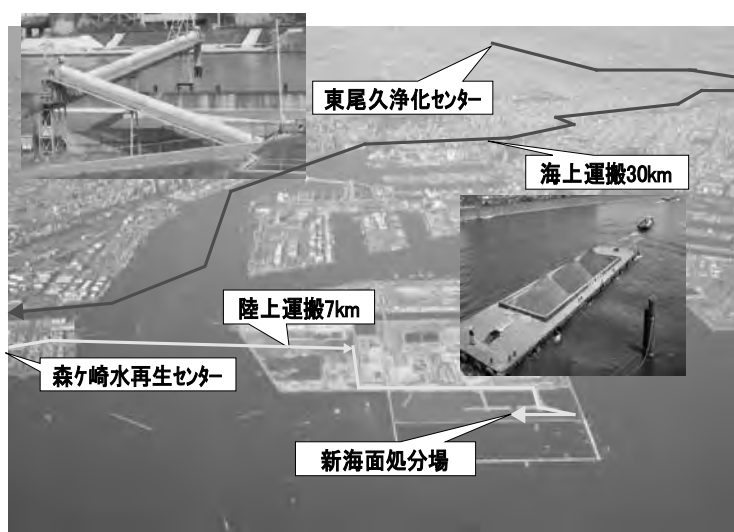
図-16 残土運搬経路
