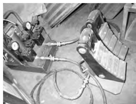
写真-6 製管機整備用油圧ジャッキ
