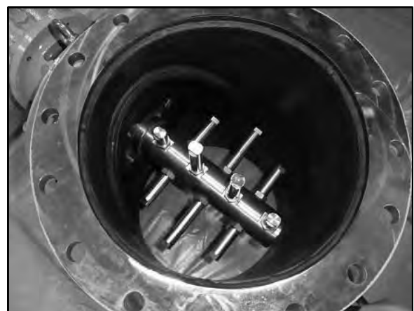
図－5 改質装置内部構造
