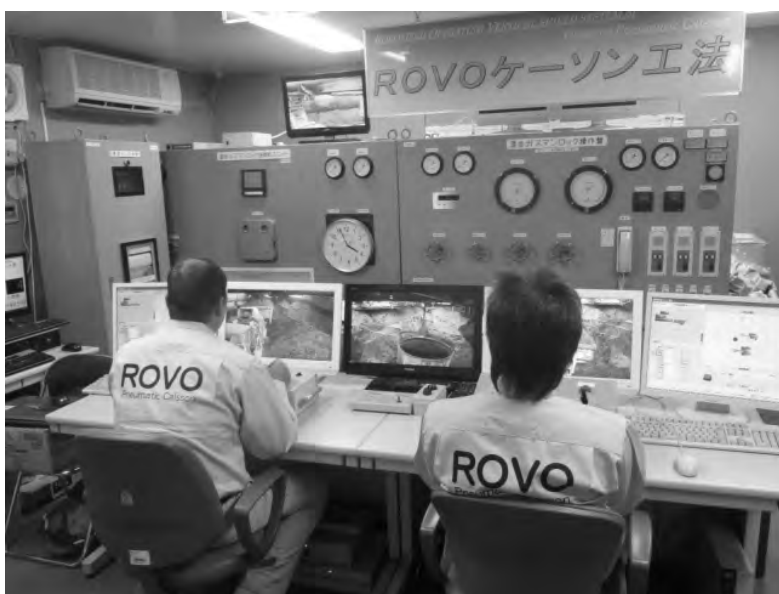
図－５ 無人掘削管理室
