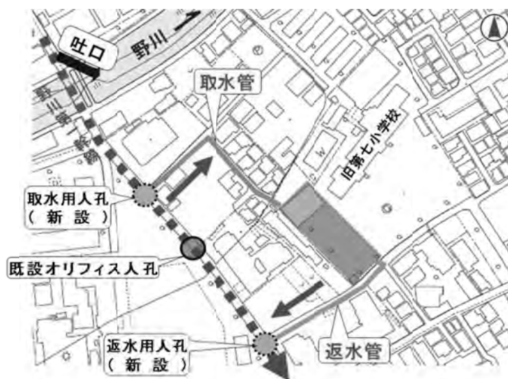
図 8 ルート案 1 取水管と返水管
