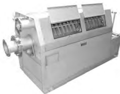
図－２ 濃縮機外観
