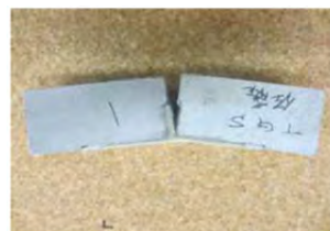
写真 1 試験後の破壊状況 荷重パターン②
