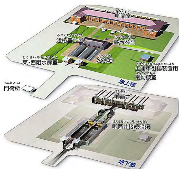
図 1 旧三河島污水処分場唧筒場施設
