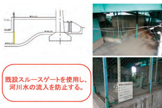
図 10 河川水の流入防止対策
