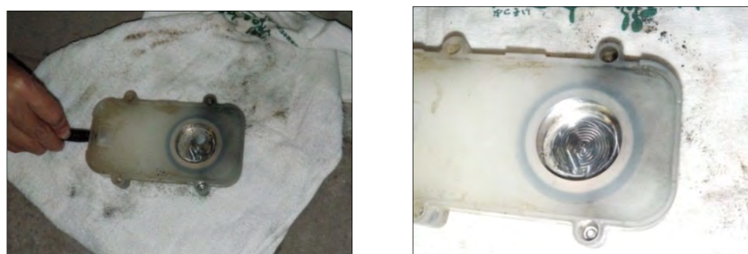
図7 耐食性試験後の水位計外観（動特性試験後）
