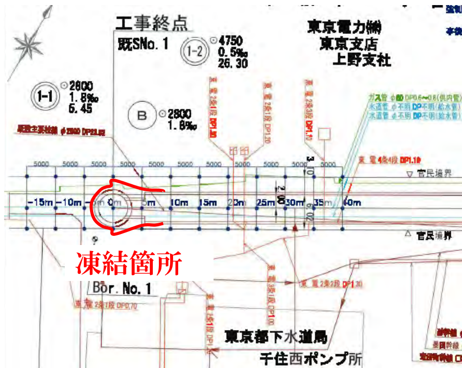
図 10 凍結工法施工箇所の地上部の測量地点
