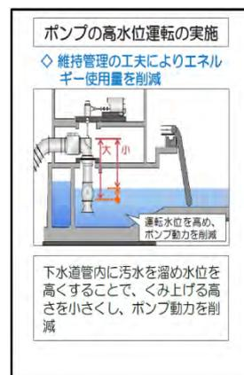
図-8 湯島ポンプ所のエネルギー使用量の割合 図-9 スマートプラン 2014 高水位運転の実施
