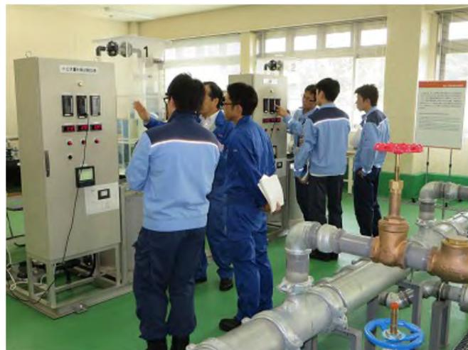
図 16 水位・流量制御試験装置
