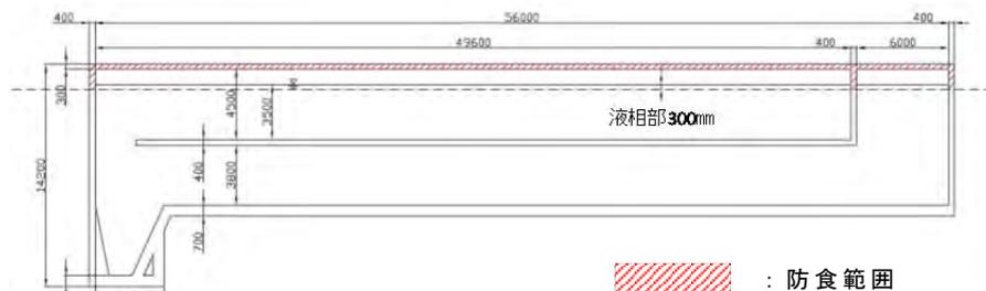
図 3 LCC 分析に用いた A センター最初沈澱池のモデル図及び防食範囲の設定
