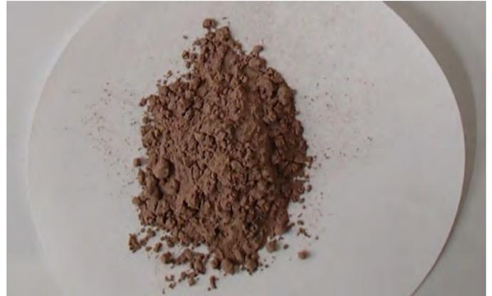
写真-3 正常運転時焼却灰の外観
