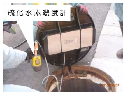
写真-3 硫化水素濃度計設置状況
