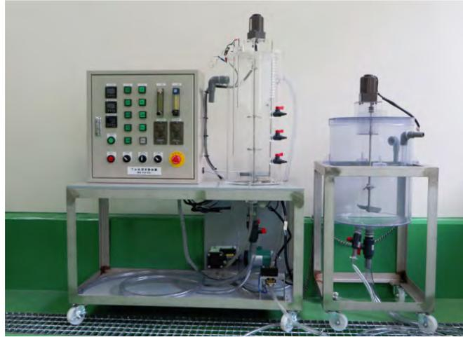
図 17 下水処理実験装置
