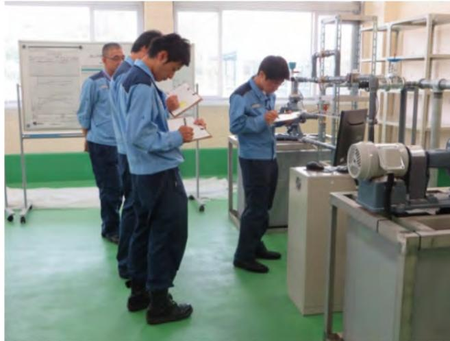
図 15 ポンプ性能試験装置
