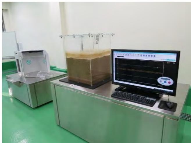
図6 消散弁作動装置、液状化装置
