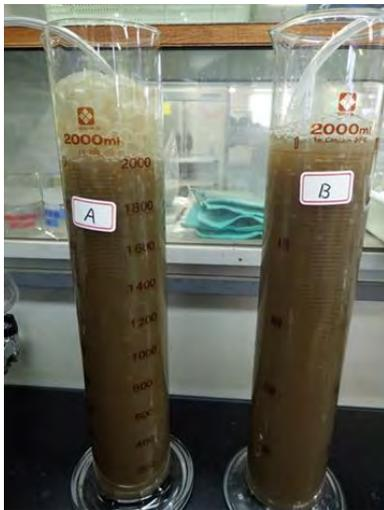
B回路入口（写真ではAと表示）およびB回路出口から試料を採取
