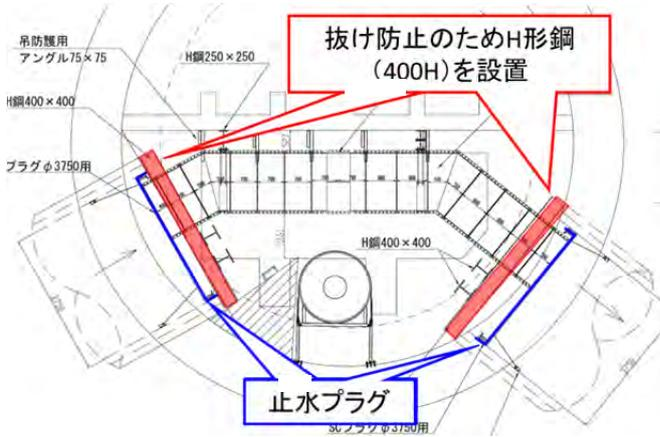
図14 H形鋼設置平面図
