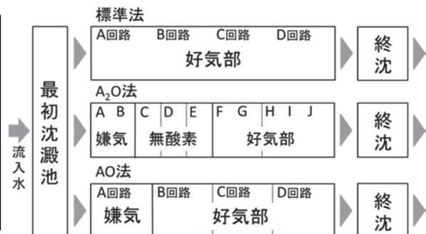
図2 各系統反応槽の概略図
