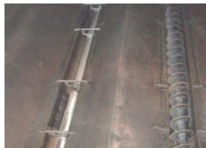
図 4 試験池内集砂装置
