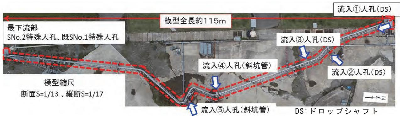
図3 水理模型全景（主要枝線φ2600mmと一連の流入管を再現）
