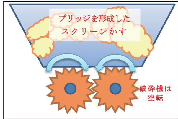
図 8 破砕機におけるブリッジのイメージ図
