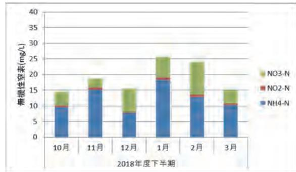
図7 深槽東系反応槽B回路末端の無機性窒素（2018年度下半期）
