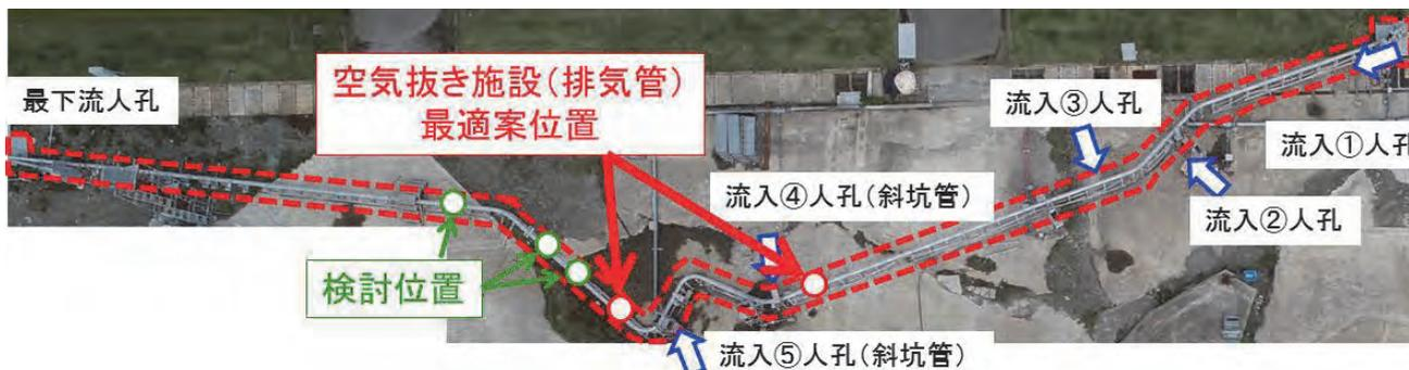
図10 空気抜き施設の検討位置
