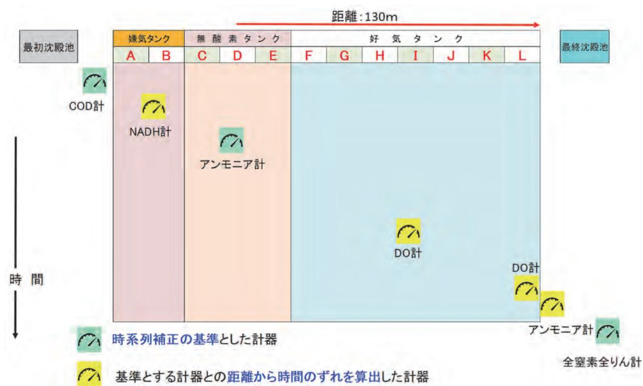
図 5 センサ設置位置と時間のずれの補正の考え方
