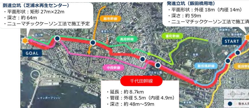
飯田橋から芝浦水再生センターまでを大深度のシールド工法で施工
