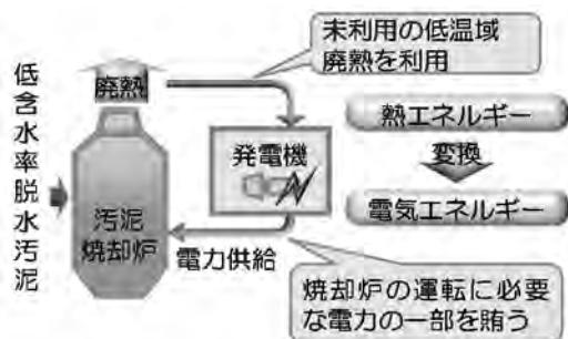
図表5-9 汚泥焼却時の廃熱を活用した新たな発電
