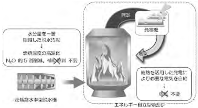
図表5-3 エネルギー自立型焼却システムのイメージ
