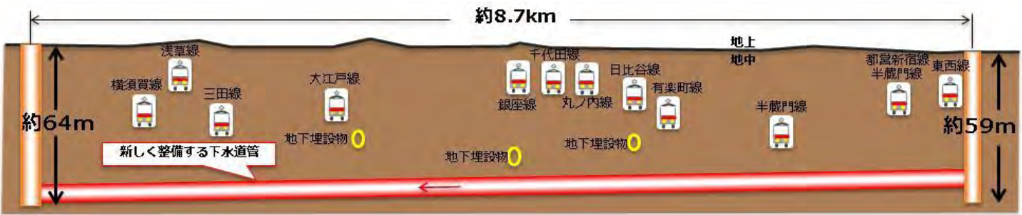
下水道管の整備イメージ（地中を真横から見た図）
