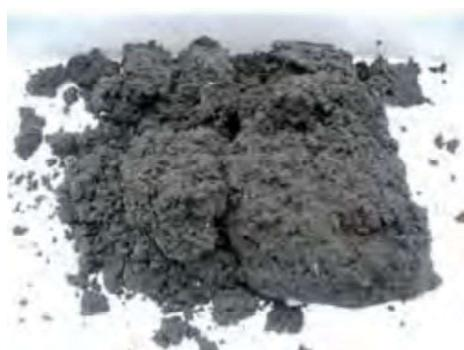
汚泥の含水率が74%以下になると、汚泥自体が燃焼しやすくなるため、補助燃料を大幅に削減することができます。
