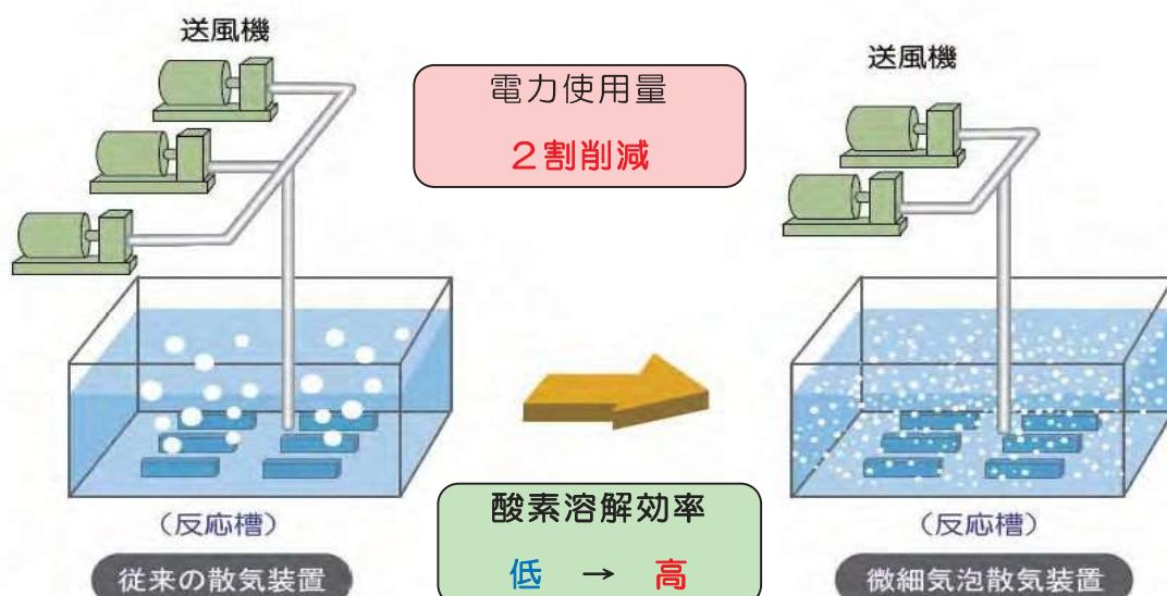
反応槽内の微生物が下水中の汚れを分解することで水をきれいにします。微生物が活発に活動できるように空気（酸素）を送り込みます。
