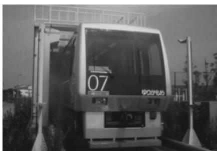
再生水による車両洗浄
