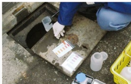
事業場排水の採水・水質検査
