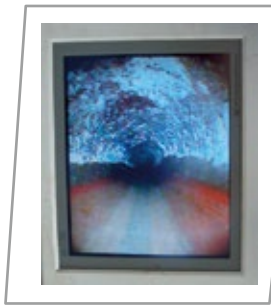
簡易なテレビカメラによる取付管の調査
