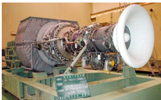
ガスタービン発電機(13,000kVA)
