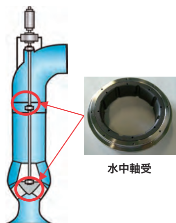
先行待機形雨水ポンプの水中軸受イメージ
