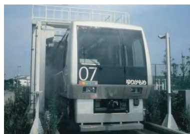
再生水による車両洗浄
