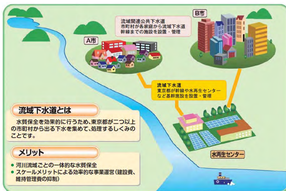
図表4-1 流域下水道のしくみ
