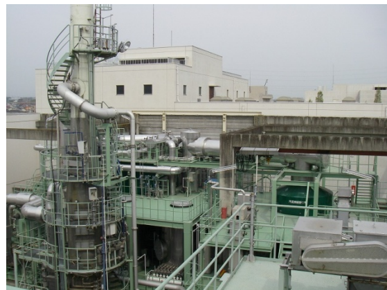
《写真:世界初の最新技術を導入した浅川水再生センターターボ型焼却炉全景》
