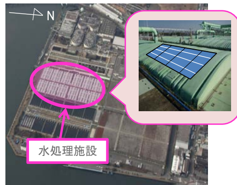
森ヶ崎水再生センターへの施設の上部空間を利用した 太陽光発電導入イメージ
