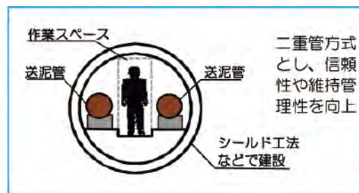
図表3-13 送泥管の再構築のイメージ図
