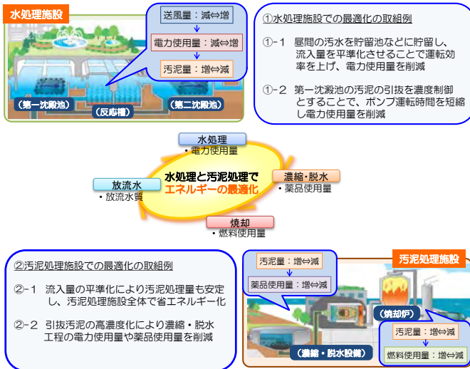
図表5-5 水処理と汚泥処理でのエネルギーの最適化の取組イメージ
